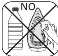
**Importante :** No utilice objetos afilados ni productos de limpieza abrasivos para limpiar la suela u otras partes de la plancha.
